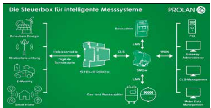
4. ábra A német okosmérési rendszer felépítése
