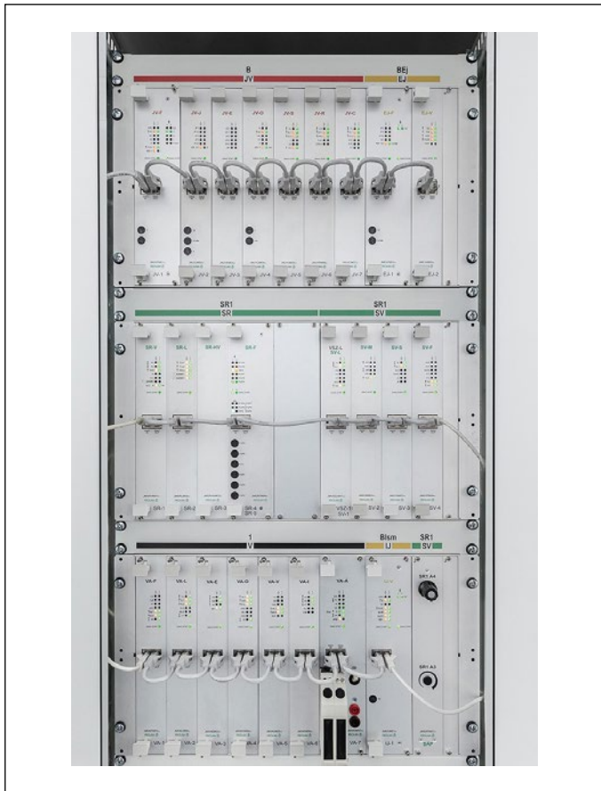
Bild 6: JM18-Frontplatte mit farbigen Informationsbalken Fig. 6: The JM18 front panel with coloured information bars
